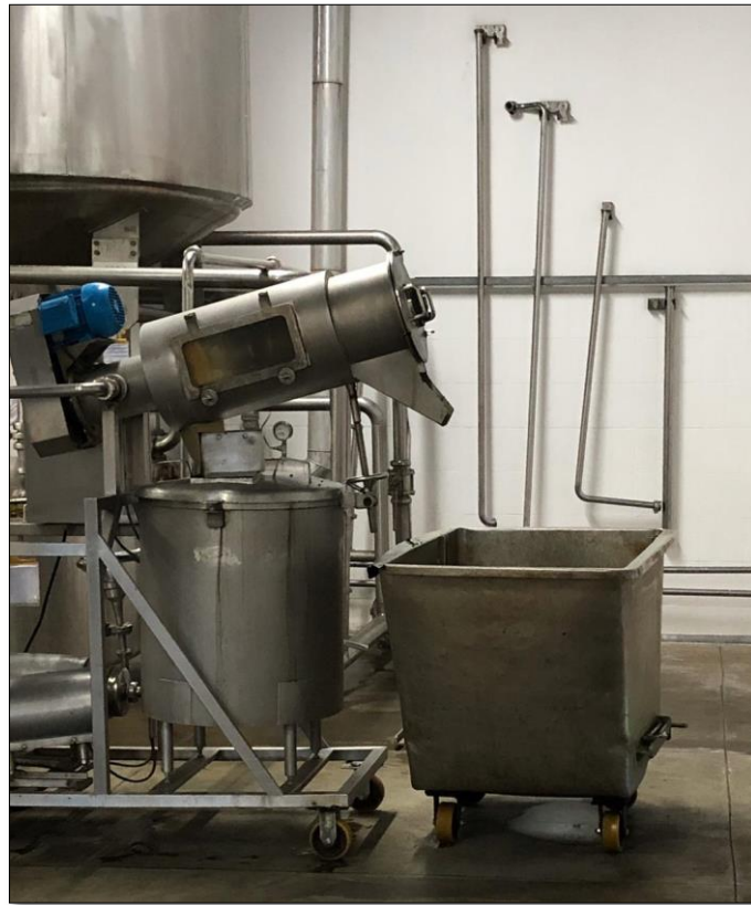
Figura 10: Filtro rotativo por onde passam a mistura a fim de separar resíduos sólidos do drenado.
