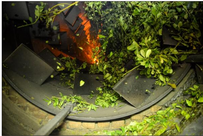
Figura 6: Tratamento térmico da matéria-prima para sua estabilização, realizada após a colheita.
