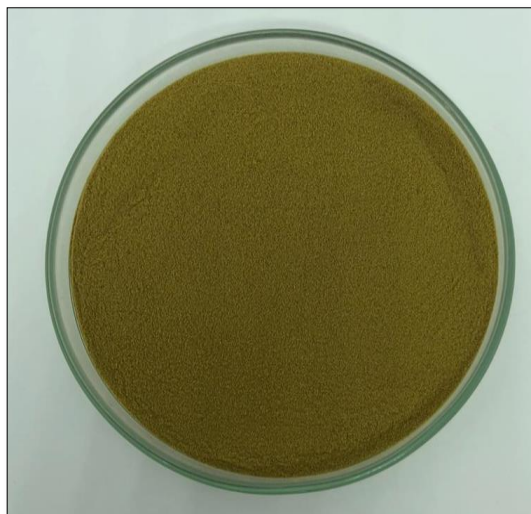
Figura 14: Amostra de extrato seco da erva-mate após passar pelo processo de secagem via Spray Dryer .
