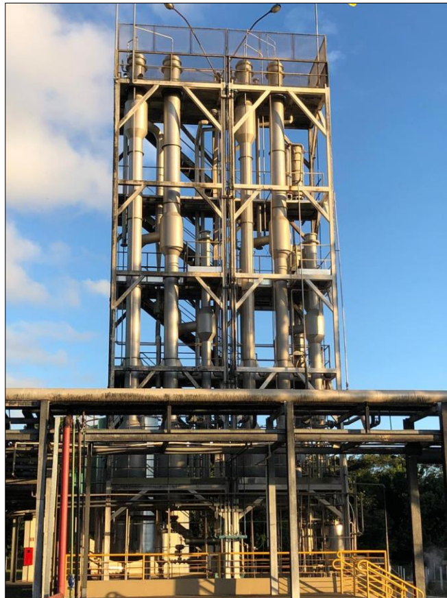
Figura 12: Concentrador tipo falling films utilizado para evaporar a água a fim de diminuir o volume do drenado.
