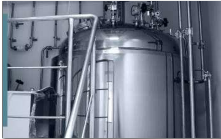
Figura 9: Reator onde são inseridas a matéria-prima e a água em camadas para a extração de metilxantinas.
