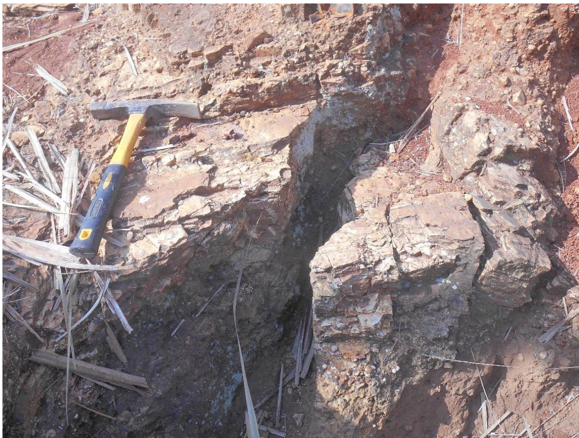
Figura 5.4 – Dobra aberta anticlinal, separada por fratura aberta e deslocamento da porção lateral esquerda, caracterizando uma falha.
