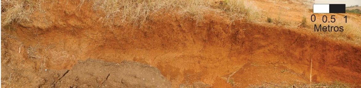
Figura 5.2 – Primeiro trecho do afloramento, com solo variando de coloração e nível laterítico visível no canto inferior esquerdo, pequenos trechos da imagem foram completados pelo software.
