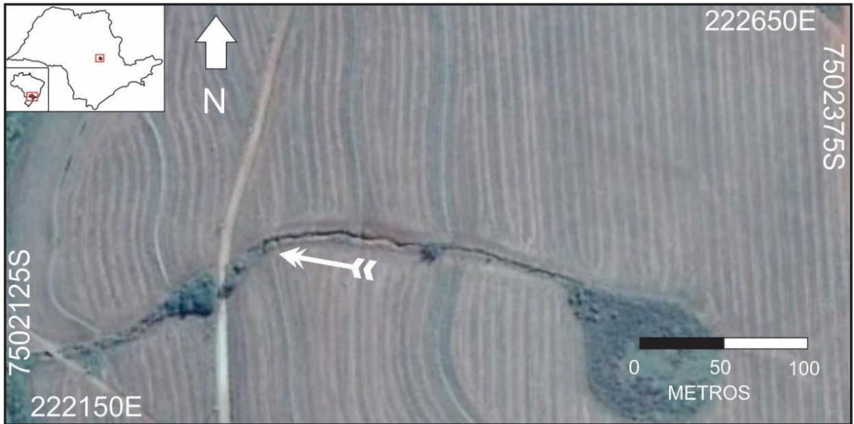
Figura 3.4 – Posição da linha de aquisição no campo, com aproximadamente 42 metros de extensão.
