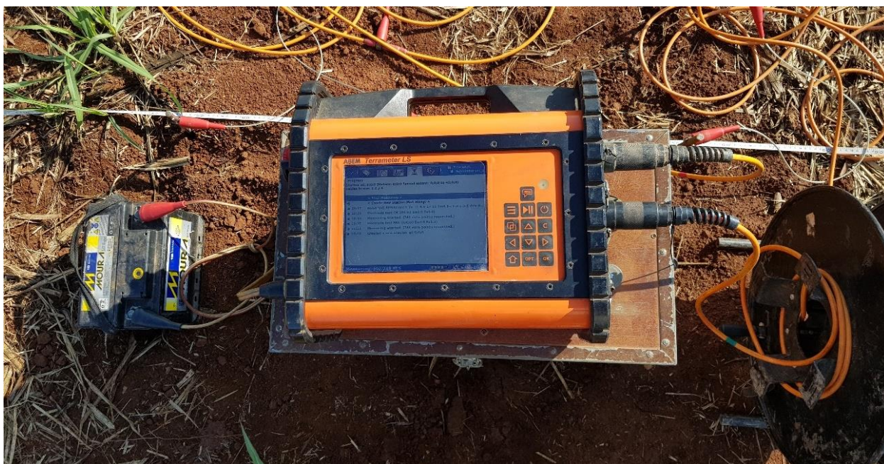
Figura 3.3 – Resistivímetro Terrameter LS no centro, com bateria a sua esquerda e eletrodos na parte superior.
