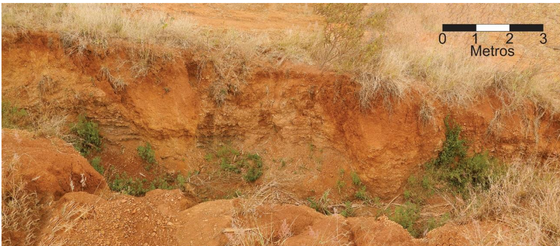
Figura 5.6 – Dois grábens próximos ao final do terceiro trecho, a parte interior dos grábens é preenchida por um solo com um nível de seixos de sílex e Laterita..
