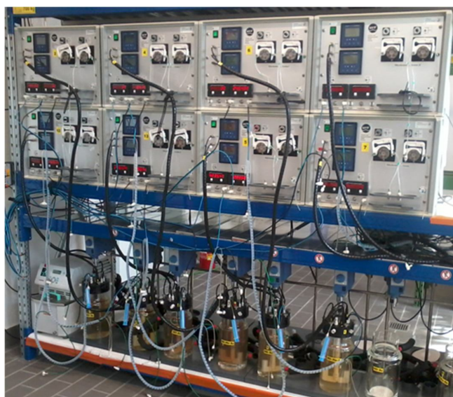
Figura 8- Equipamento usado para controle do potencial redox (Eh), pH e temperatura
