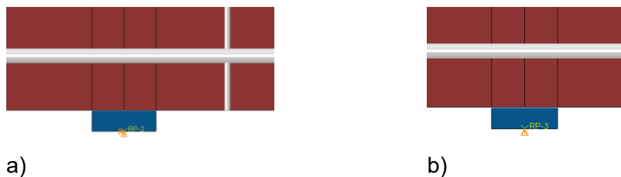
Figura 13 - Condições de contorno aplicadas nos apoios: a) esquerdo e b) direito dos modelos numéricos.
