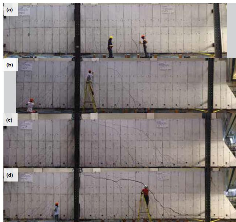
Figura 3 - Ensaios realizados em vigas de 4 metros de altura.
