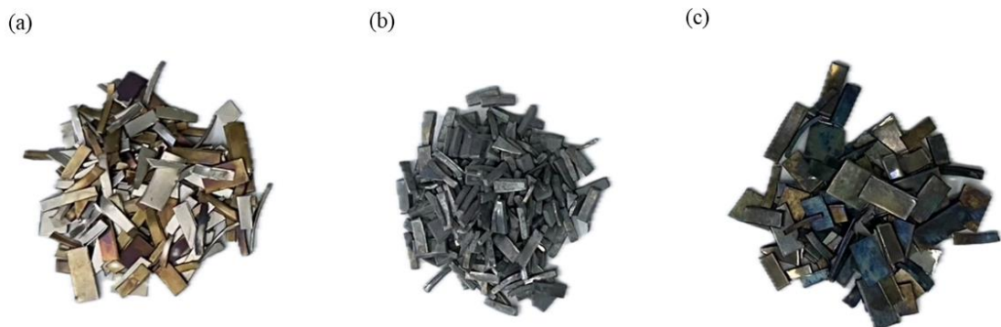
Figura 19 - Metais empregados na obtenção da liga Ti15Zr15Mo: (a) titânio; (b) zircônio e (c) molibdênio.
