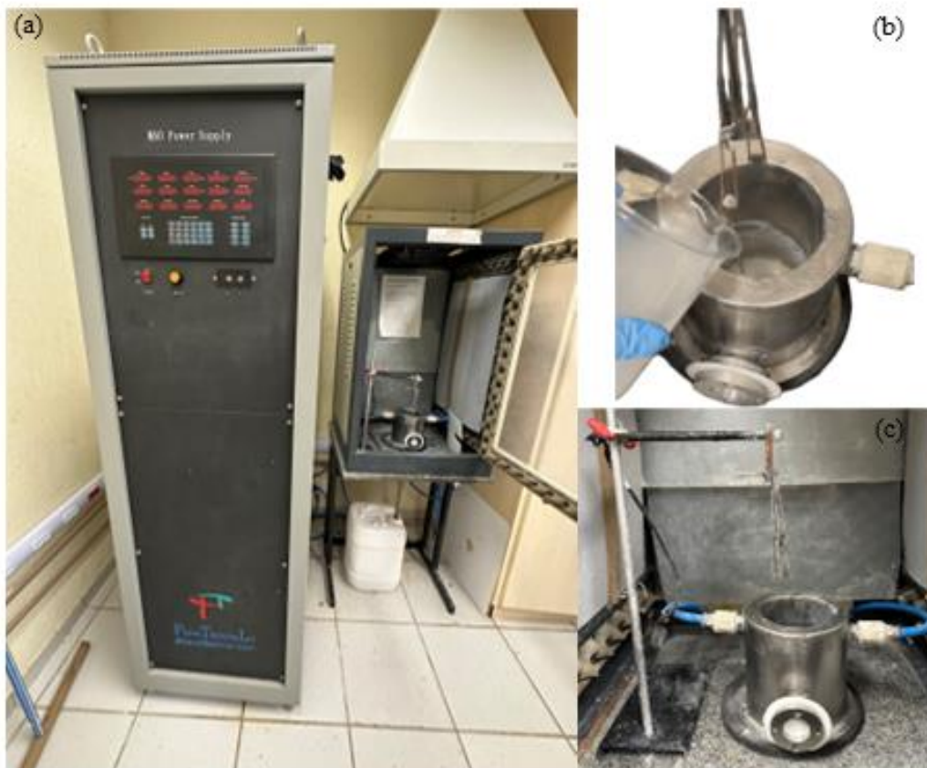
Figura 24 - (a) Equipamento MAO-30, utilizado para o tratamento de superfície da liga Ti15Zr15Mo, (b) e (c) Esquema para a realização da PEO.
