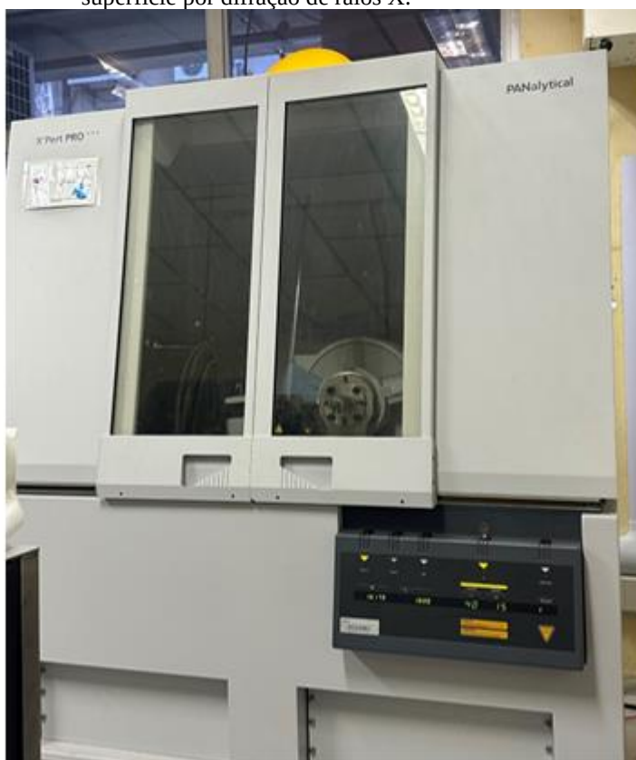
Figura 33 - Difratômetro utilizado para realizar a caracterização da liga Ti15Zr15Mo após a modificação da superfície por difração de raios X.
