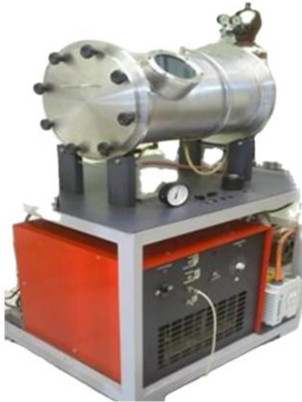
Figura 20 - Forno a arco voltaico utilizado no processamento da liga Ti15Zr15Mo.
