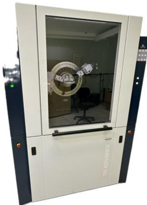
Figura 26 - Difratorômetro utilizado para realizar a caracterização da liga Ti15Zr15Mo após a modificação da superfície por difração de raios X.
