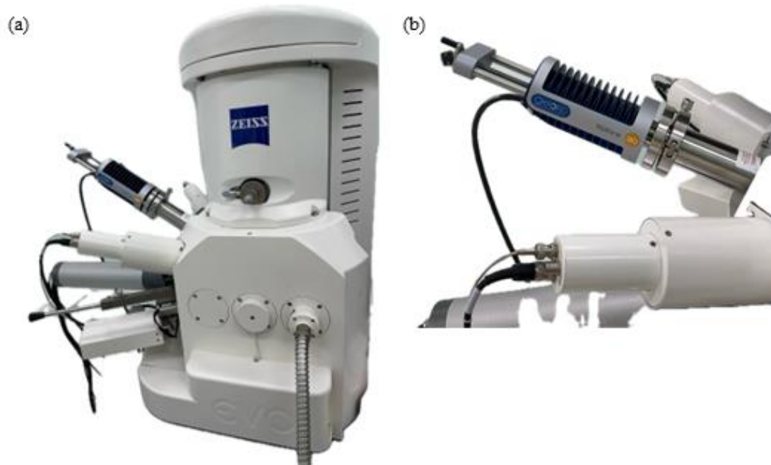
Figura 25 - (a) Microscópio eletrônico de varredura e (b) Espectrômetro detector de energia dispersiva, utilizados para a caracterização da morfologia e da análise elementar das amostras da liga de Ti15Zr15Mo após o tratamento da superfície por oxidação por plasma eletrolítico.
