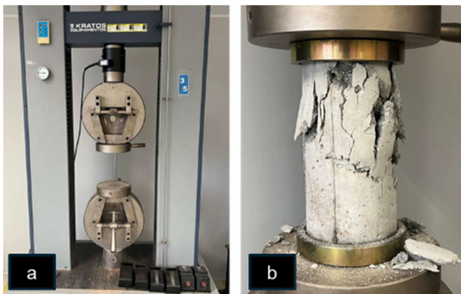
Figura 19 - (a) Máquina utilizada nos ensaios e (b) corpo de prova após ruptura por compressão.
