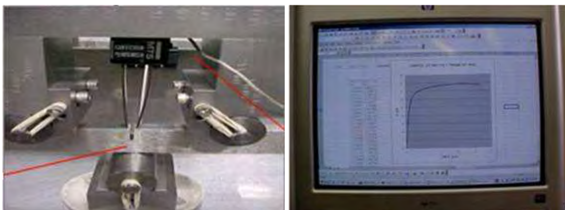
Figura 3.13 - Modo de fixação do extensômetro para medição do deslocamento da ponta da pré-trinca.
