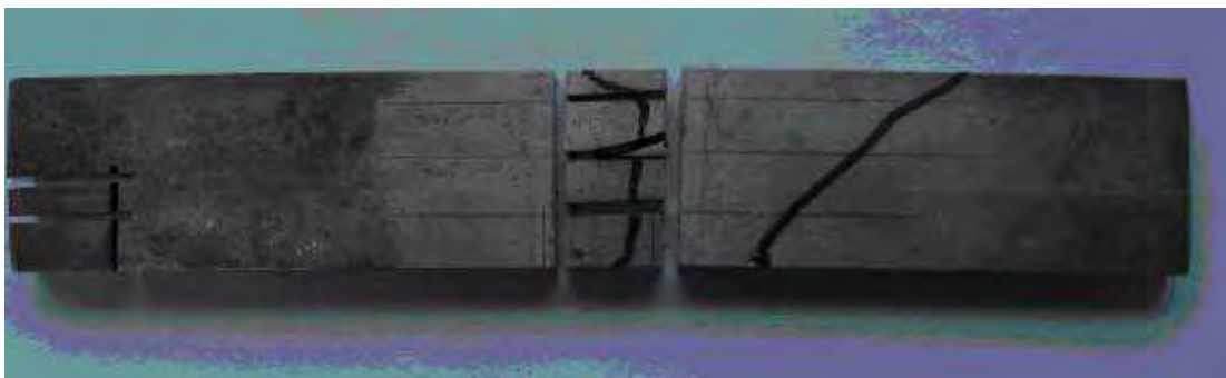
Figura 3.4: Esquema de retirada das amostras para micrografia das regiões da ZTA.
