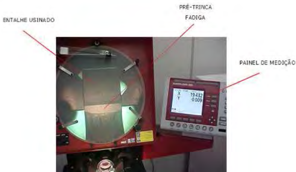
Figura 3.14 – Projetor de perfis Mitutoyo para medição da pré-trinca.
