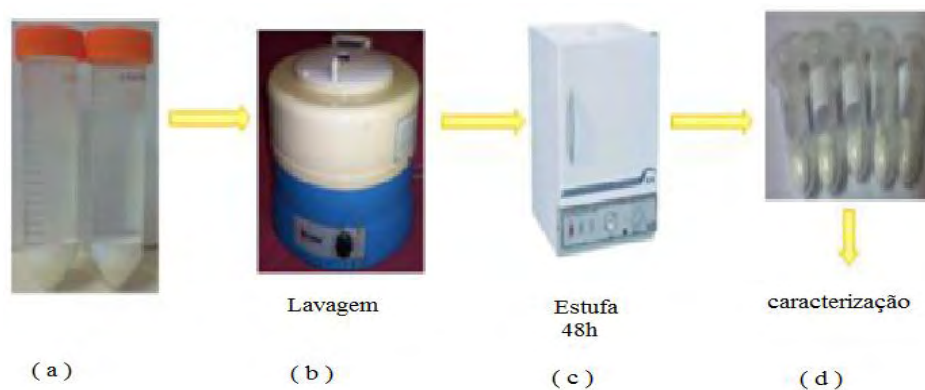
Figura 13- (a) Solução resultante após centrifugação; (b) lavagem das nanopartículas; (c) secagem das nanopartículas; (d) obtenção das nanopartículas de \text{CeO}_2 e \text{Ce}_{1-3/4x}\text{La}_x\text{O}_2 (adaptado de LIMA, 2010)
