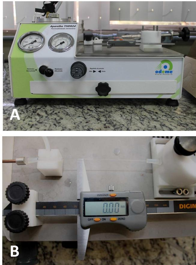
Figura 6 – A) Aparelho para mensuração da permeabilidade dentinária; B) Peças que compõem a máquina de permeabilidade (Capilar de vidro e paquímetro digital).
