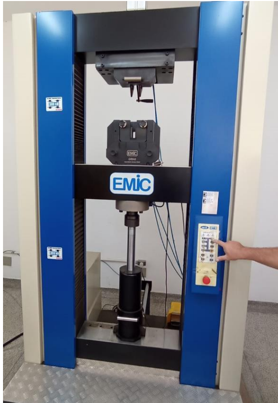
Figura 7 - Prensa EMIC para ensaio de resistência à compressão
