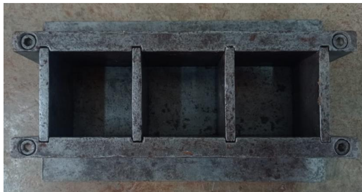
Figura 5 - Molde metálico nas dimensões 50 x 50 x 50 mm
