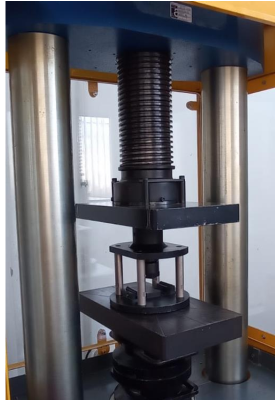
(b) Local de inserção dos CPs para o ensaio de resistência à compressão
