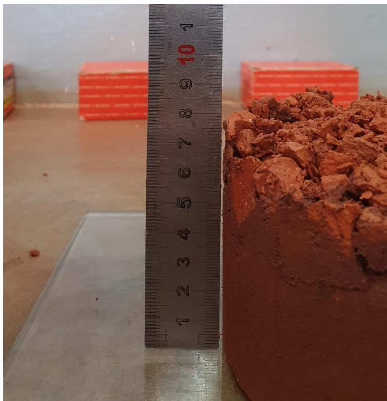
Figura 22 – Medição do cravamento no CP4.
