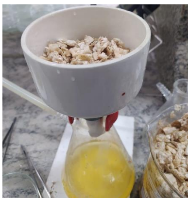
Figura 112 – Processo de filtração da biomassa
