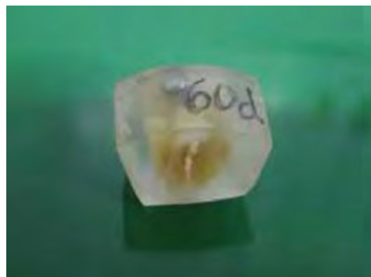
FIGURA 19: Bloco ósseo (tibia) contendo o implante incluído em resina Metil Metacrilato.
