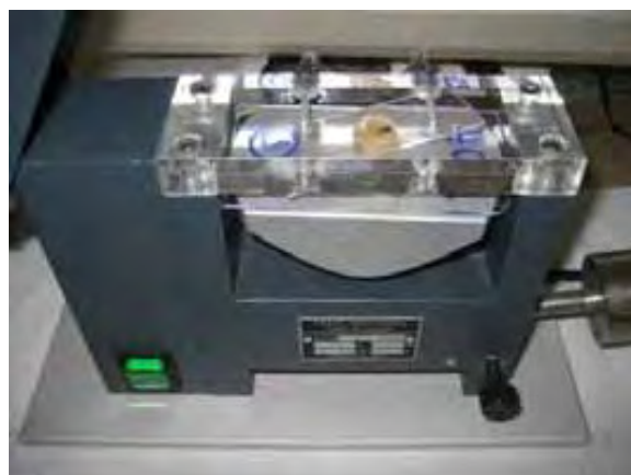
FIGUR 21: Adesão do corpo de prova na lâmina no aparelho do Sistema Exakt®.
