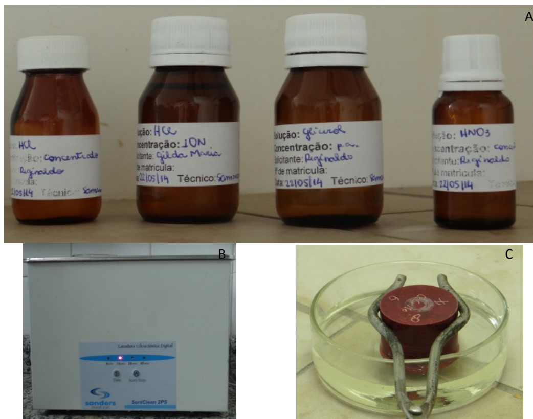
Figura 6 – Sequência de ataque ácido da superfície metálica. a) Substâncias químicas utilizadas para o ataque ácido; b) cuba ultrassônica utilizada para limpeza dos espécimes; c) Imersão dos espécimes em solução de ataque.
