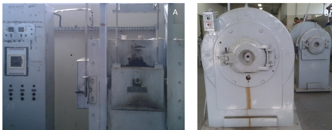
Figura 5 – a) Forno utilizado para aquecimento dos espécimes antes da forja; b) Máquina de forjamento rotativo (Laboratório de Estruturas, Departamento de Aeronáutica, Engenharia Metalúrgica – ITA).
