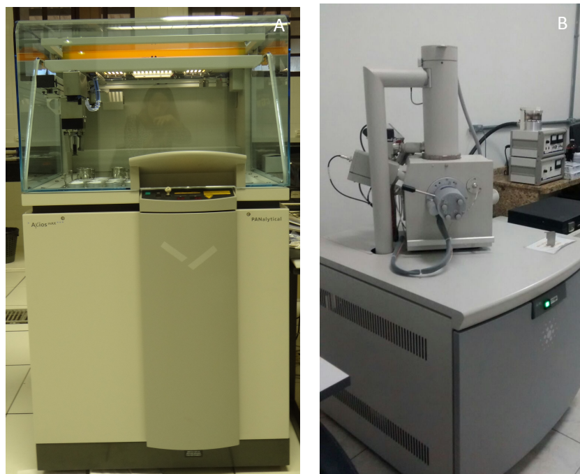
Figura 8 – a) Equipamento para análise de fluorescência (Laboratório de caracterização Química, Escola de Engenharia de Lorena, EEL-USP); b) Microscópio eletrônico de varredura (Laboratório de Materiais Odontológicos e Prótese, Instituto de Ciência e Tecnologia, ICT, UNESP).
