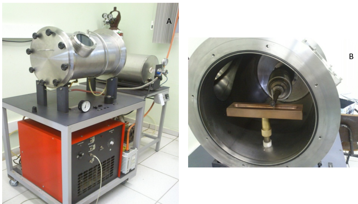
Figura 4 – a) Forno a arco voltaico (Departamento de Materiais e Tecnologia, Faculdade de Engenharia de Guaratinguetá, FEG – Unesp); b) Interior do forno.
