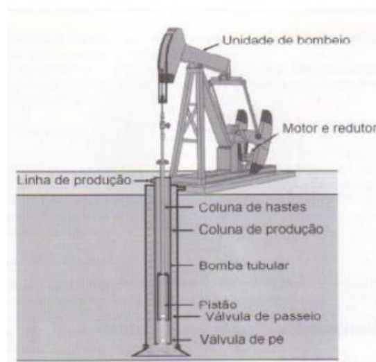
Figura 17 – Estrutura de bombeio mecânico
