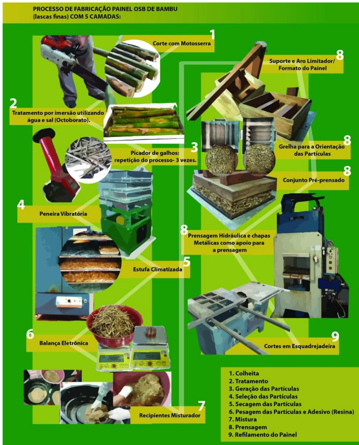
Figura 10. Processo de fabricação dos painéis 100% bambu natural.
