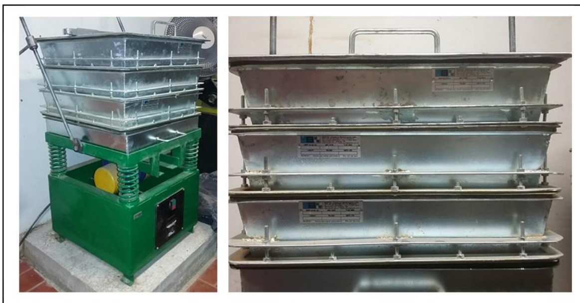
Figura 14. Peneira Vibratória para a seleção das partículas.
