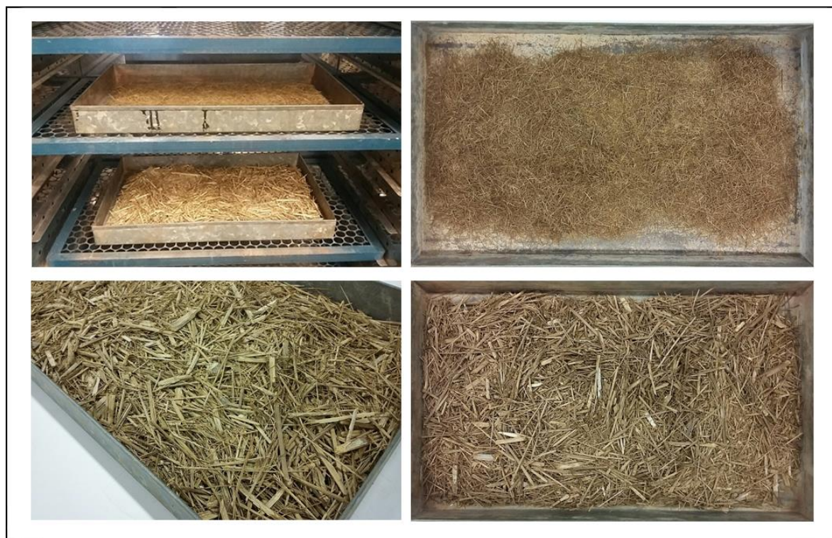
Figura 26. Partículas com tratamento térmico a 180°C e 200°C.
