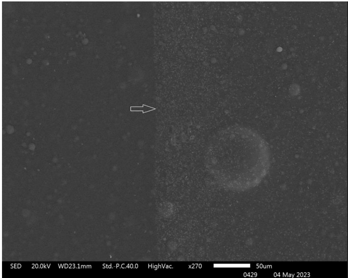
Figura 22: Fotografia de MEV, evidenciando os limites de uma colônia de Xac, na presença de ramnolipídeo. Tensão de 20 kV e aumento de 270x. A seta branca indica os limites da colônia (a direita) de Xac.
