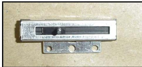
Figura 16- Sensor de deslocamento (Potenciômetro linear).
