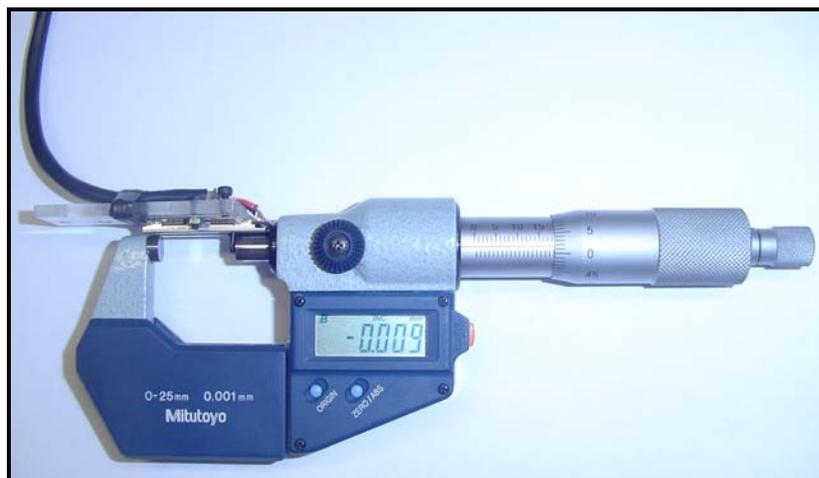
Figura 17- Sensor de deslocamento ajustado ao micrômetro digital para calibração.
