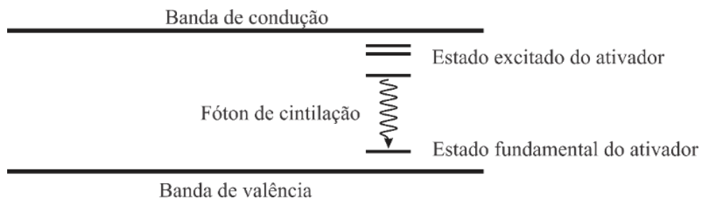
Figura 19 – Estrutura da banda de energia de um cristal cintilador ativado.
