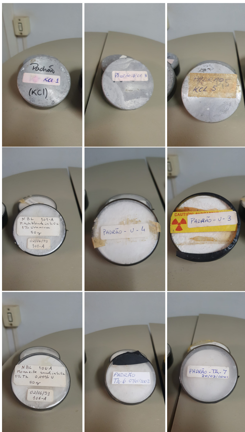
Figura 45 – Padrões utilizados na calibração dos sistemas gamaespectrométricos de Duarte (2002) e Cecatto (2021) com a definição da uniformidade da geometria dos invólucros hermeticamente selados.
