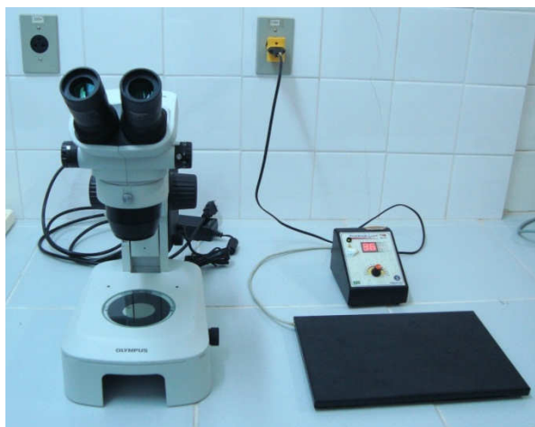
Figura 2: Estereomicroscópio (Olympus SZ51) utilizado para visualização e seleção dos COCs; e placa aquecedora para controle da temperatura em 35°C para os COCs.
