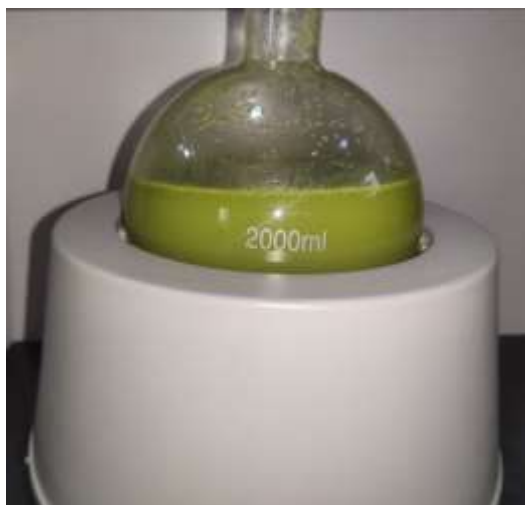
Figura 3 - Balão de destilação com a matéria da amostra de Citrus latifolia Tanaka (limão-taiti) já inserida em conjunto com água destilada
