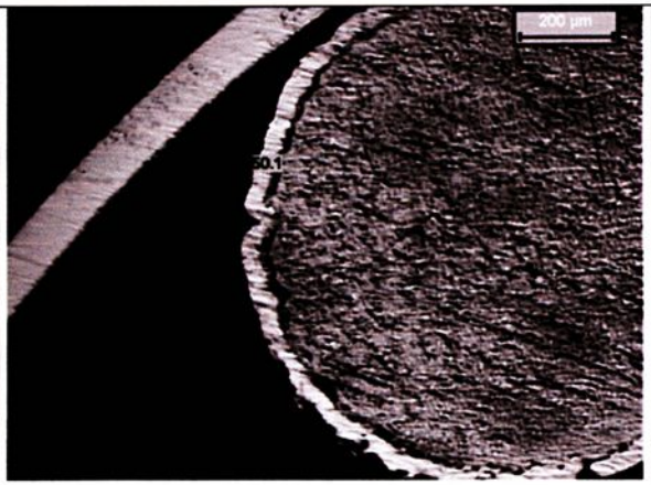
Figura 4.42 – Medida de espessura do depósito no M4 (-95mV) na planta experimental
