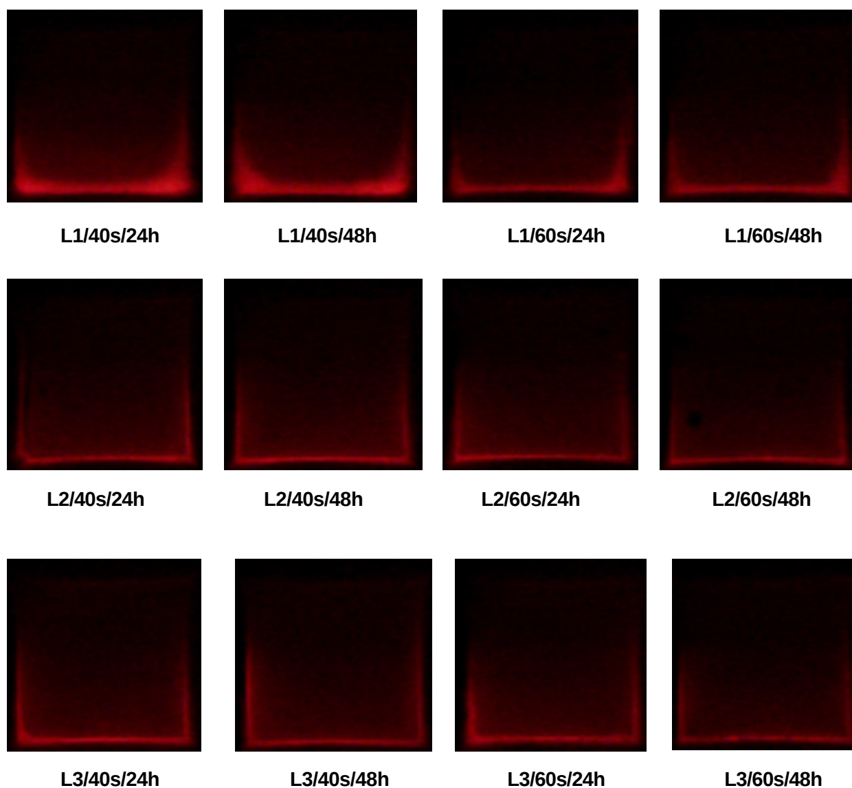
FIGURA 15. Imagens obtidas do grupo L (sistema LEDs; 1/micropartícula, 2/híbrida, 3/compactável; 40s/60s polimerização; 24h/48h imersão no corante).
