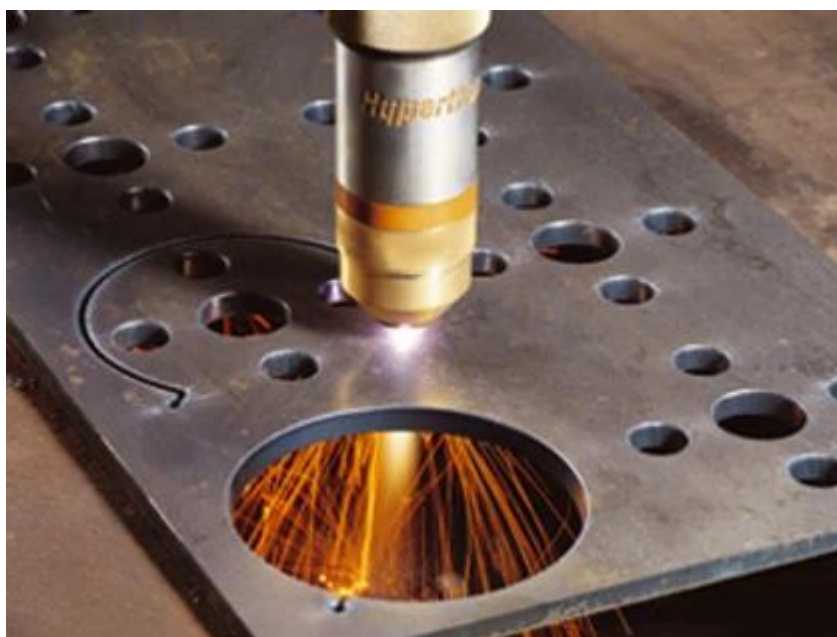
Figura 17 - Chapa metálica recebendo recortes a plasma
