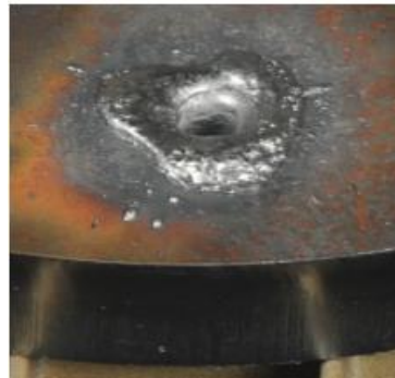
Figura 33 - Escória gerada pelo processo de oxicorte
