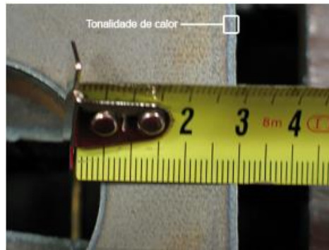
Figura 31 - Tonalidade de calor após recorte por plasma (2mm)
