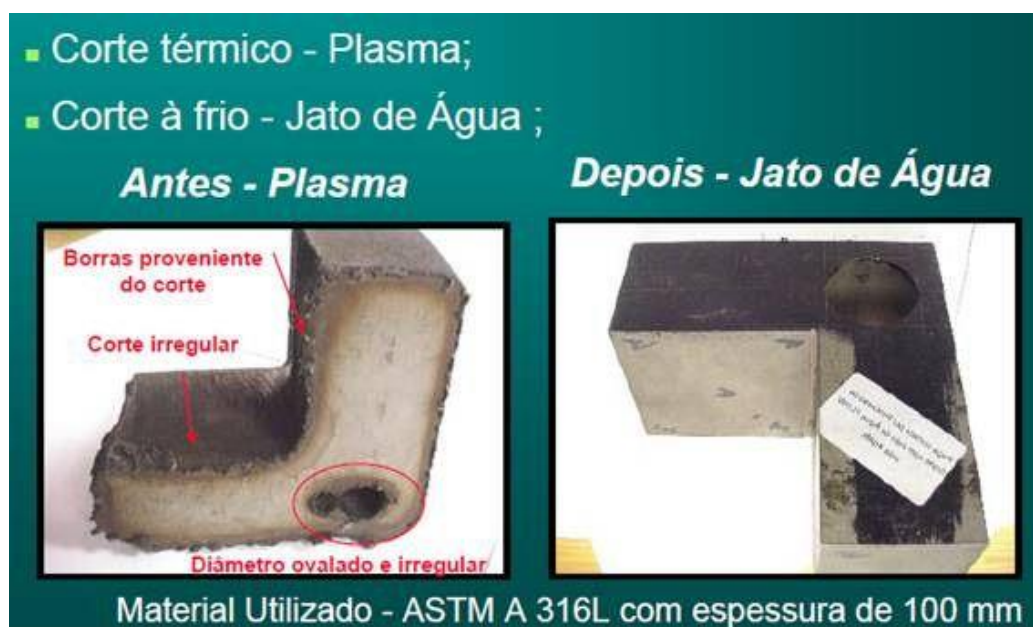
Figura 38 - Corte à plasma e à frio
