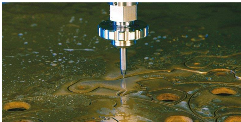
Figura 29 - Recortes feitos por máquina de corte por jato de água
