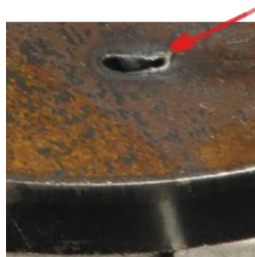
Figura 34 - Escória gerada pelo processo de plasma
