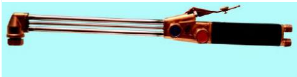
Figura 15 - Maçarico com misturador no bico
