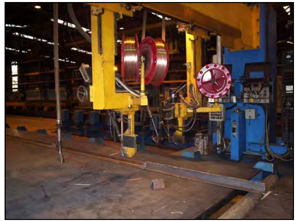
FIGURA 3.2. Equipamento de soldagem a arco submerso – ICEC/Bady Bassit.
