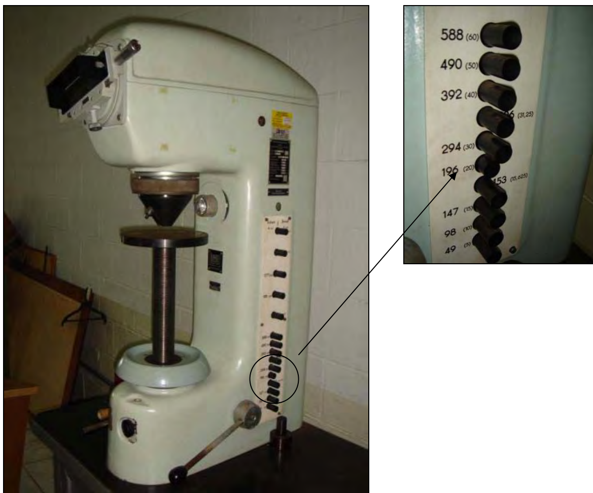
FIGURA 3.12. Equipamento utilizado nos ensaios de dureza.
