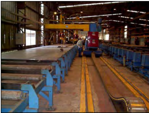
FIGURA 3.2. Equipamento de soldagem a arco submerso – ICEC/Bady Bassit.
