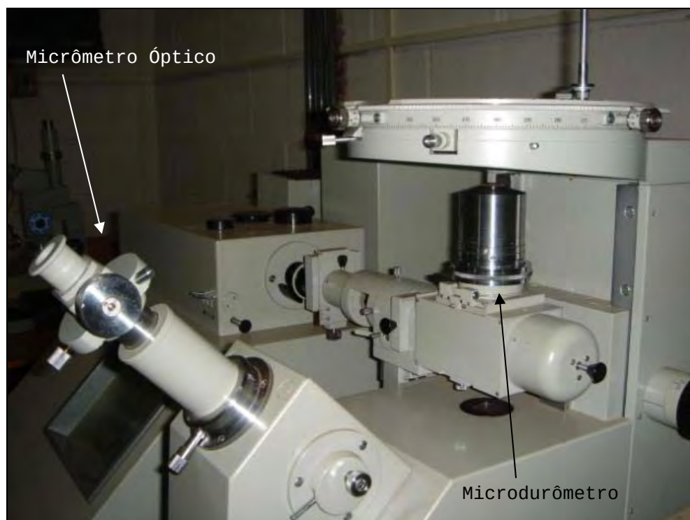
FIGURA 3.15. Microdurômetro acoplado ao microscópio Neophot .
