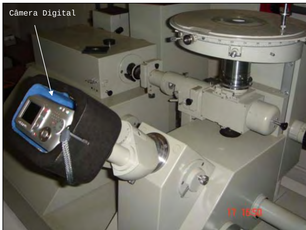
FIGURA 3.16. Câmera Digital acoplada ao microscópio Neophot .
