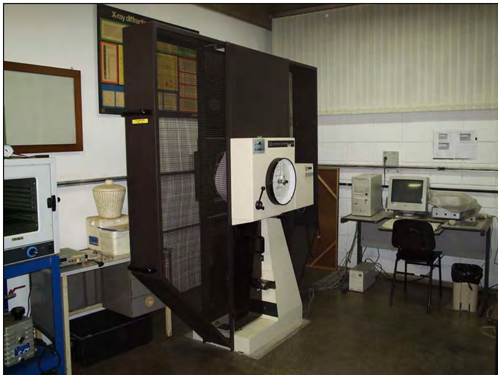
FIGURA 3.11. Equipamento Instron Wolpert utilizado no ensaio de impacto.
