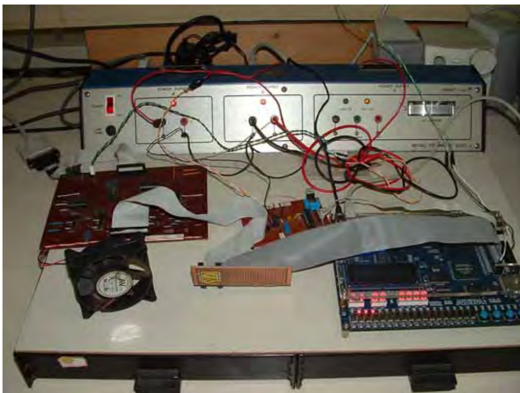
Figura 6.4 - Foto do processador NCAP e do módulo STIM implementado no Kit de desenvolvimento NIOS II.
