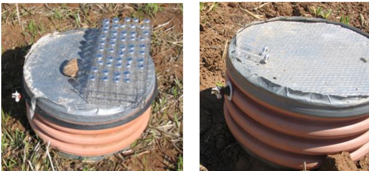
Figura 4. Câmara estática fechada utilizada para fazer as amostragens de GEE na Estação experimental “El Encín”
