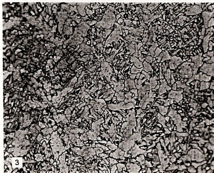
Fig. I - Macrografia da região da soldagem e fotomicrografias das microestruturas mais relevantes (AÇO I).
