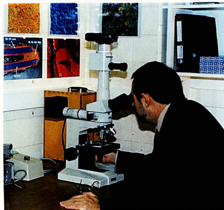
Fig. 6.7 - Microscópio metalográfico NIKON-Optiphot-m, com objetivas de até 100x e ocular de 10x .
