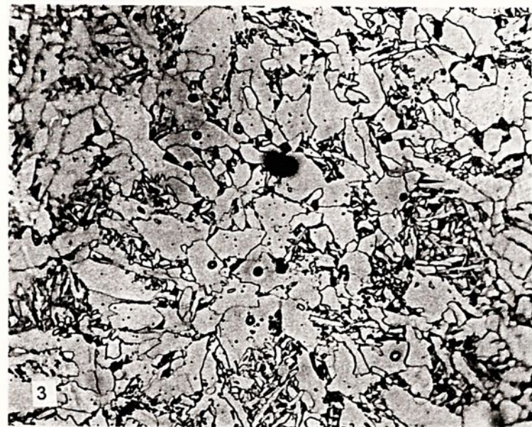
Fig. II - Macrografia da região da soldagem e fotomicrografias das microestruturas mais relevantes ( AÇO II ).
