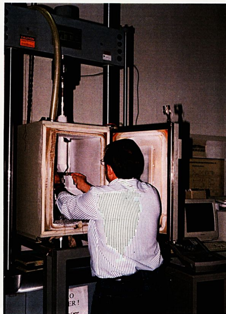
Fig. 7.21 - Reservatórios de nitrogênio líquido e abertura rápida da câmara fria para a colocação do CDP em seu interior.
