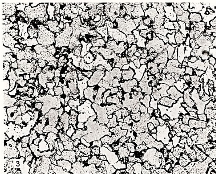
Fig. IV - Macrografia da região da soldagem e fotomicrografias das microestruturas mais relevantes ( AÇO IV ).
