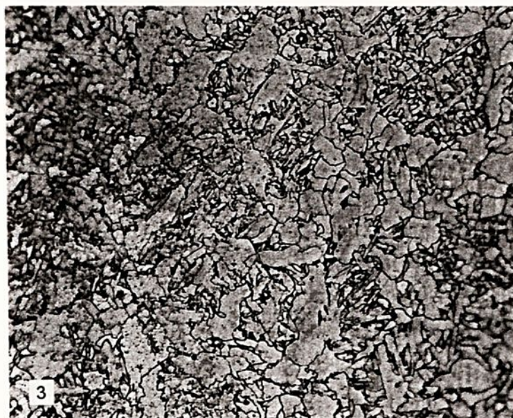
Fig. 1 - Macrografia da região da soldagem e fotomicrografias das microestruturas mais relevantes (AÇO I).
