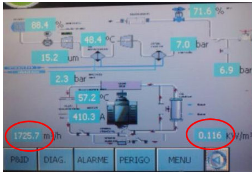
Figura 77 - Modulação do compressor Samsung SM 2000
