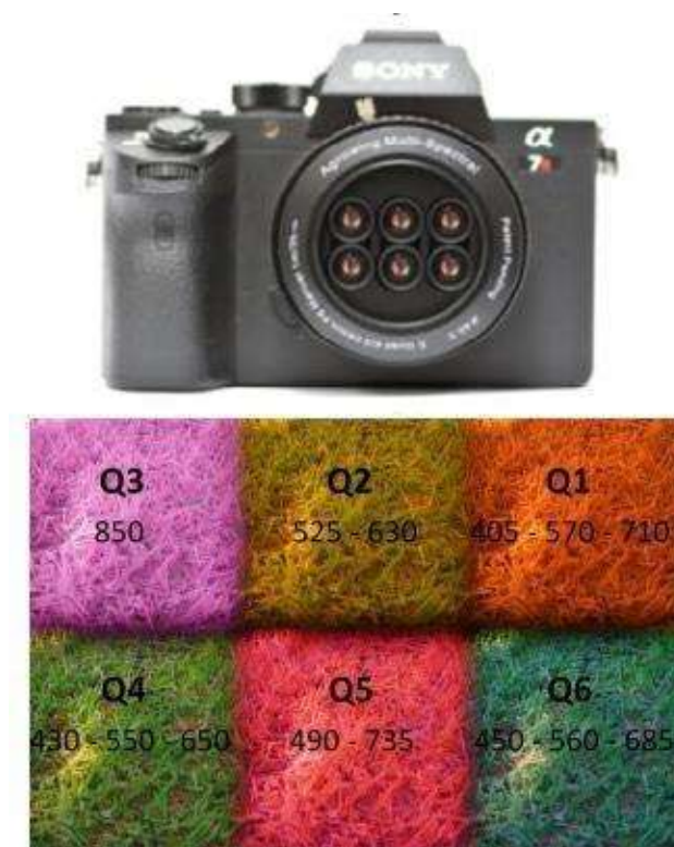
Figura 12 — Câmara Sony Alpha 7R XXX (Agrowing) , com seis cabeças e 14 bandas espectrais.
