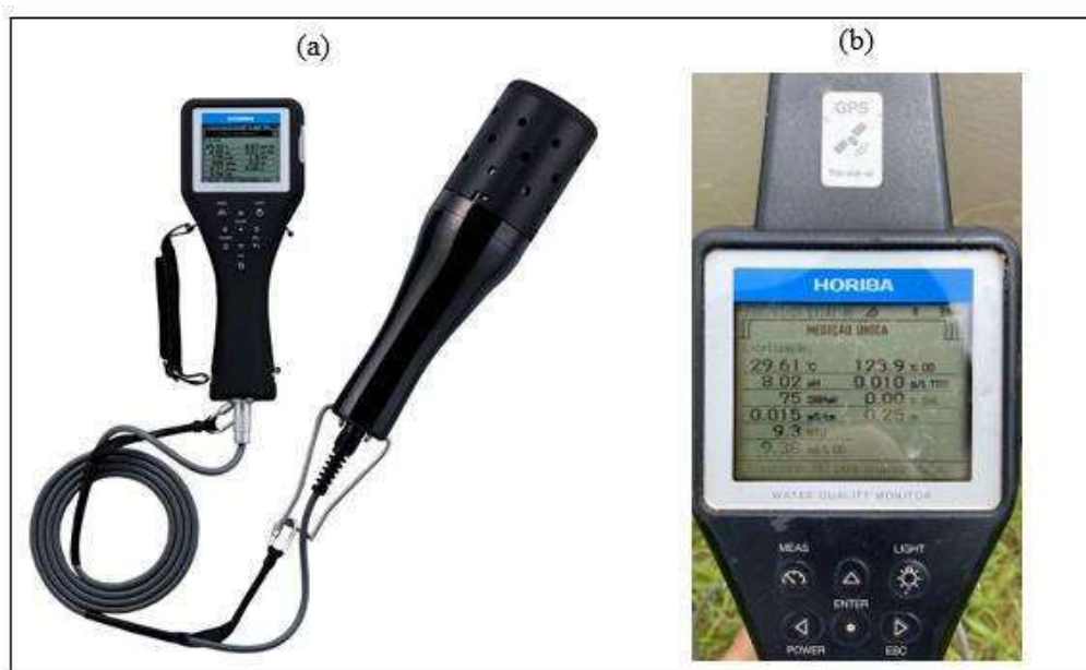
Figura 10 — (a) Sonda multiparâmetros ( Horiba U-50 ) com monitor, cabo de 30 m e sonda submersível; (b) monitor mostrando variáveis registradas.
