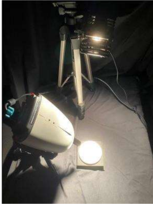
Figura 15 — Placa cinza de campo, cuja radiância foi medida em laboratório, com o auxílio de uma lanterna de luz halógena e um espectrorradiômetro.
