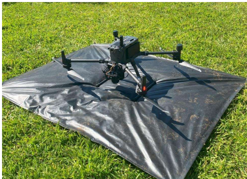
Figura 14 — ARP Matrice 300 RTK sobre uma lona pronta para a decolagem.
