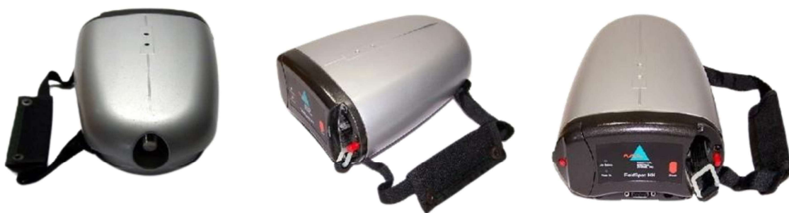
Figura 11 — Espectrorradiômetro ASD FieldSpec® HandHeld UV/NIR utilizado para obtenção de medidas de radiométricas in situ .
