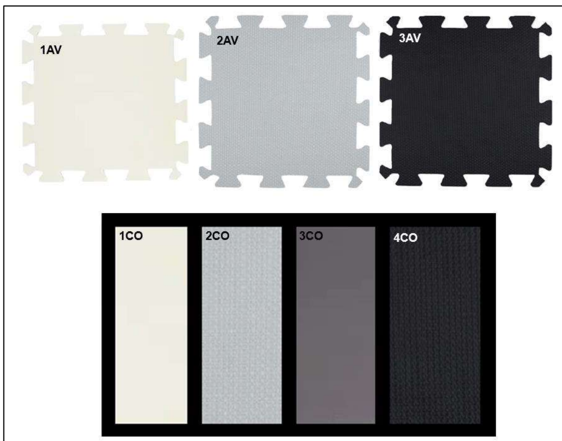
Figura 16 — Alvos de referência em quatro cores: branco (1AV e 1CO), cinza claro (2AV e 2CO), cinza escuro (3CO) e preto (3AV e 4CO), para a calibração radiométrica das imagens.
