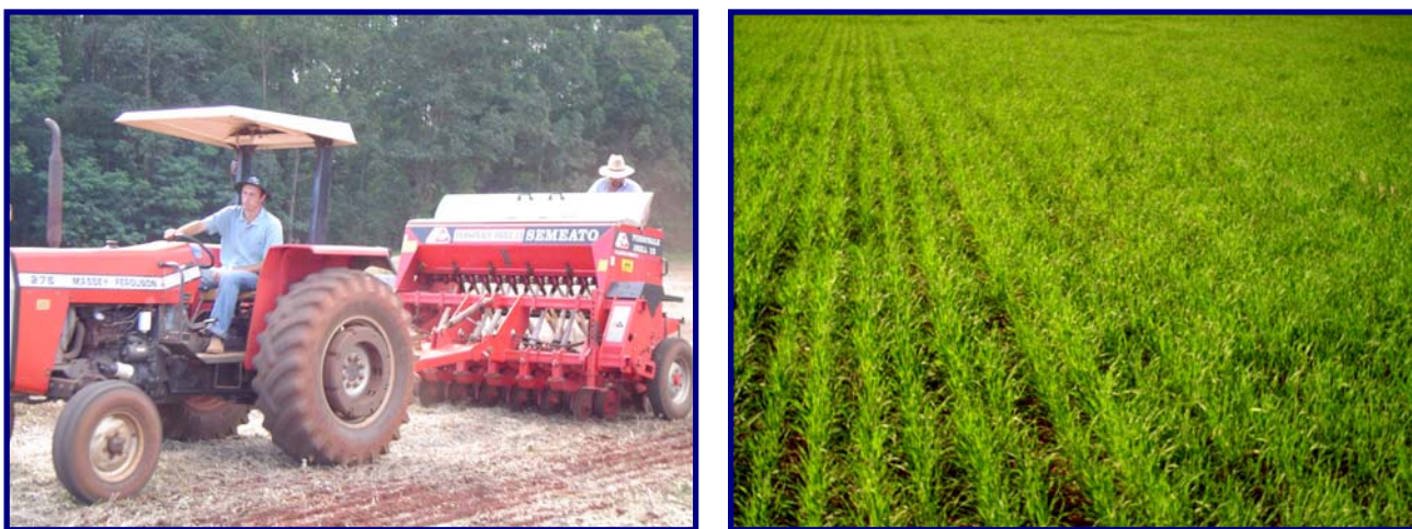
Figura 4. Detalhe da Semeadora-adubadora (Semeato, modelo THM 13 – Personale Drill) no momento da semeadura e vista geral do milho aos 20 DAE.
