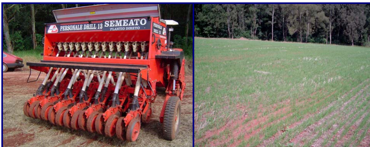
Figura 2. Detalhe da Semeadora-adubadora (Semeato, modelo THM 13 – Personale Drill) e vista geral do tritcale aos 10 DAE.
