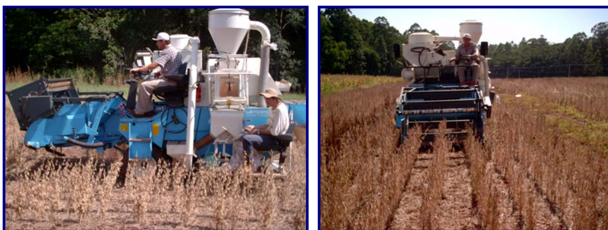
Figura 3. Detalhe da colhedora de parcelas automotriz marca Wintersteiger SeedMech, modelo Nursery Master Elite.
