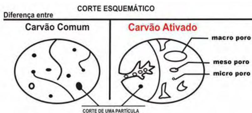
Figura 22. Corte esquemático de uma partícula de carvão comum e ativado.
