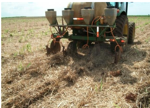
Figura 2. Implemento de aplicação de nematicida e inseticida utilizado na aplicação injetada do inoculante após o corte.
