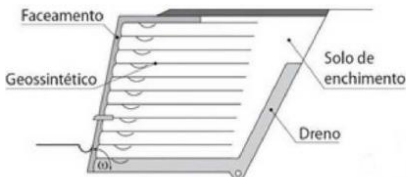
Figura 6 - Muro de solo reforçado
