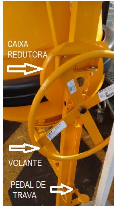
Figura 9: Engrenagens e pedal de travamento da betoneira.
