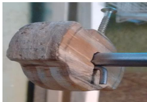
Figura 12: Mecanismo de transferência de força do redutor para o eixo.
