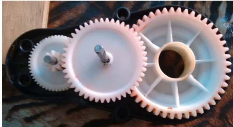
Figura 25: Vista: em corte do redutor.
