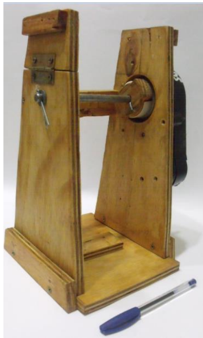
Figura 31: Instalação do conjunto de movimentação do parapodium.
