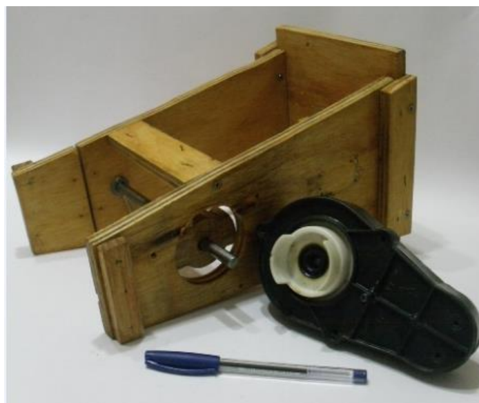
Figura 30: Conjunto de movimentação do parapodium: redutor adaptável, acoplamento de madeira e eixo traseiro do parapodium.
