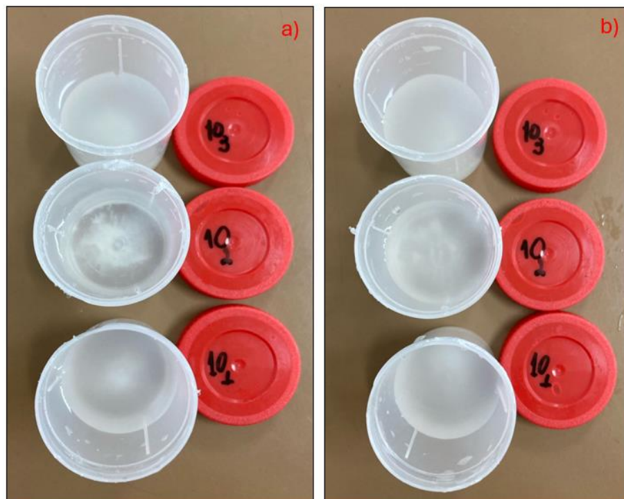
Figura 36 - Amostras de HA10 degradadas. a) 72 horas e b) 120 horas.
