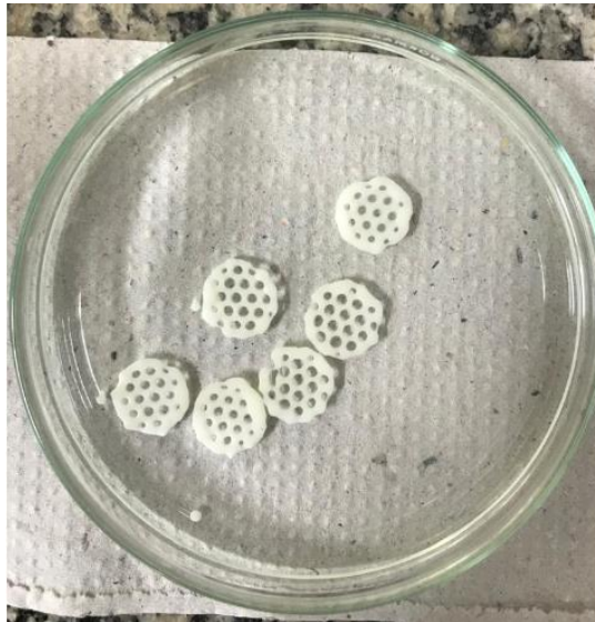
Figura 12 - Processo de reticulação com \text{CaCl}_2 .
