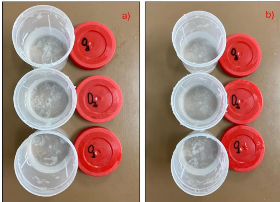
Figura 33 - Amostras de AS degradadas. a) 72 horas e b) 120 horas.
