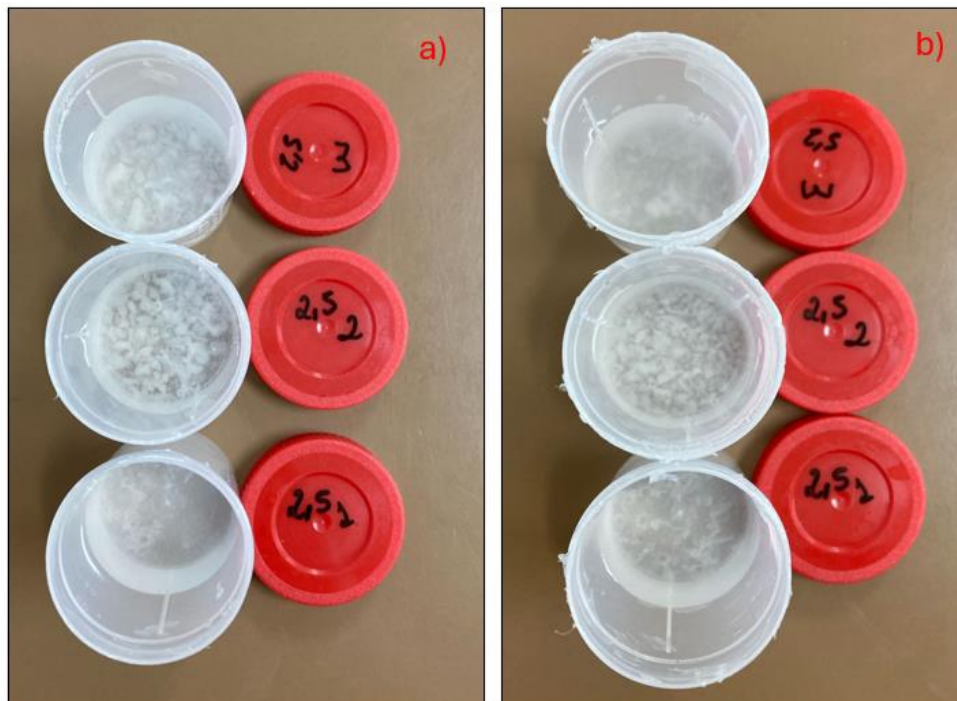
Figura 34 - Amostras de HA2,5 degradadas. a) 72 horas e b) 120 horas.
