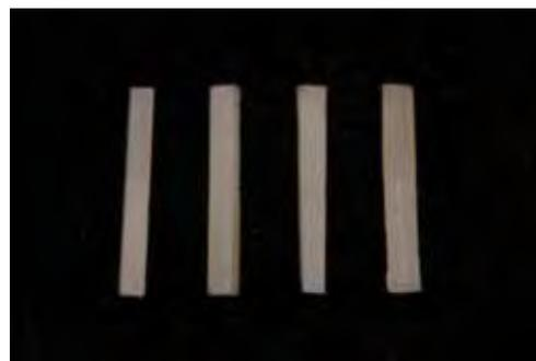
Figura 9 e 10 - Conjunto cerâmico/cimento resinoso com base metálica e cp em forma de barra
