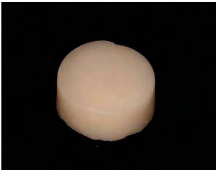
Figura 1 - Amostra para análise de pH com dimensões 6,4mm x 2,4mm.
