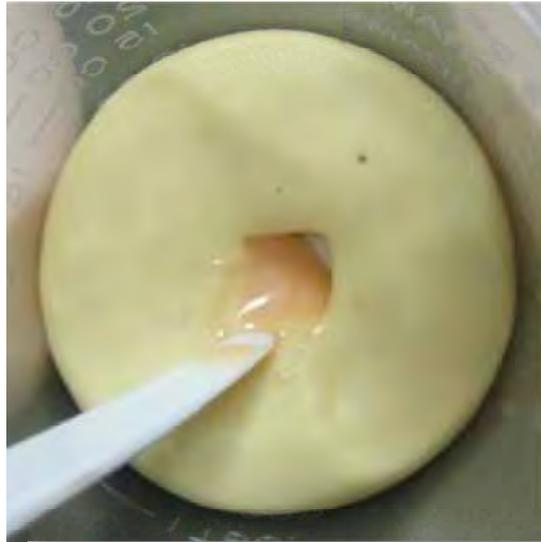
Figura 8 - Cimento resinoso sendo aplicado sobre a superfície cerâmica.
