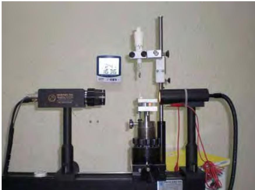
Figura 6 - Goniômetro utilizado para medição do ângulo de contato.
