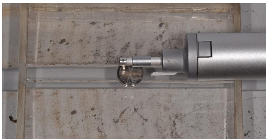
Figura 2 - Disco de Ti posicionado para a leitura da rugosidade superficial
