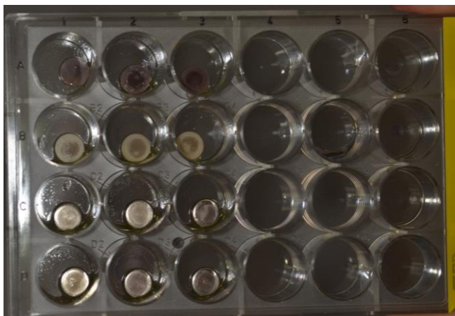
Figura 7 - Corpos de prova após a adesão celular por 24 horas e remoção do MTT
