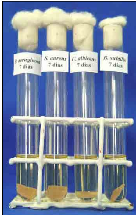
FIGURA 12: Corpos-de-prova referentes aos grupos G III, G IV e G V para os microrganismos avaliados, após 7 dias de incubação a 37°C
