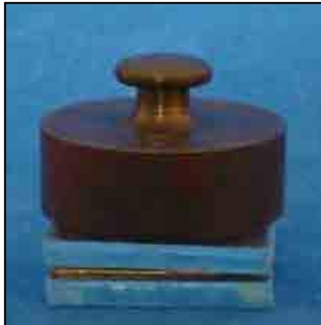
FIGURA 2: Peso posicionado sobre o corpo-de-prova
