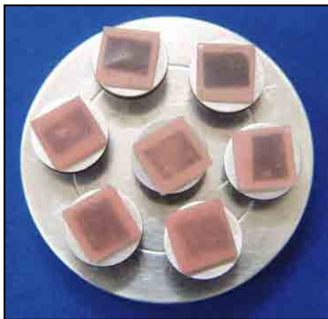
FIGURA 9: Corpos-de-prova montados em stubs
