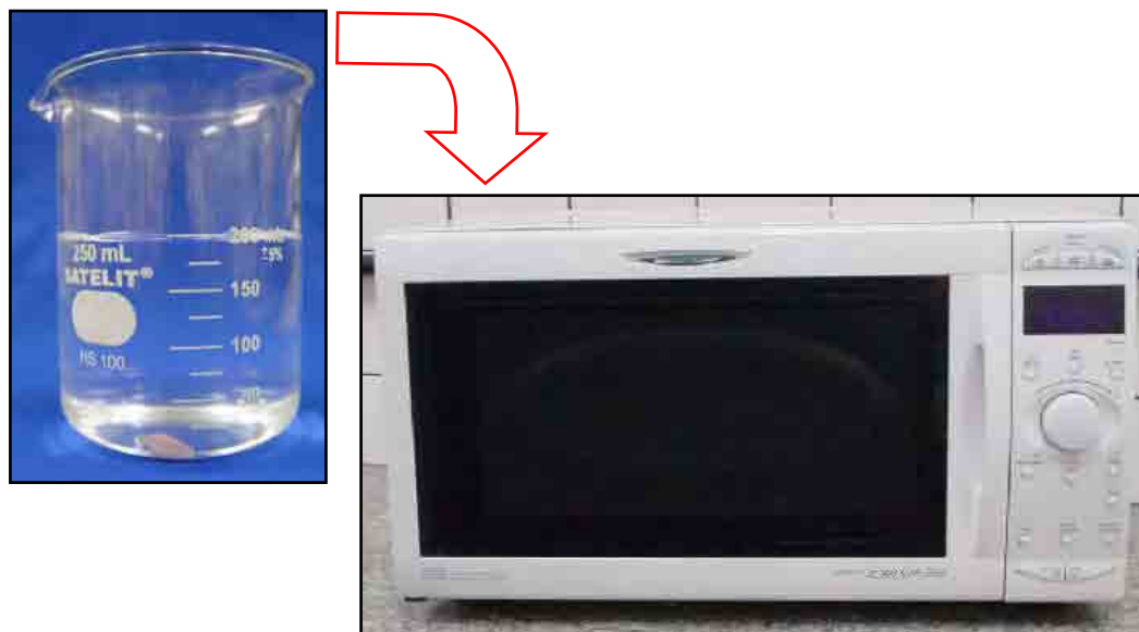
FIGURA 8: Corpo-de-prova imerso em recipiente com 200 mL de água destilada estéril para ser submetido à irradiação no forno de microondas
