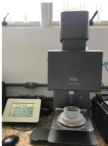
Figura 3 – Fornos utilizados para cristalização convencional (A - Programat EP5000, IvoclarVivadent; B - Vita Vacumat 6000 MP, Vita Zahnfabrik)
