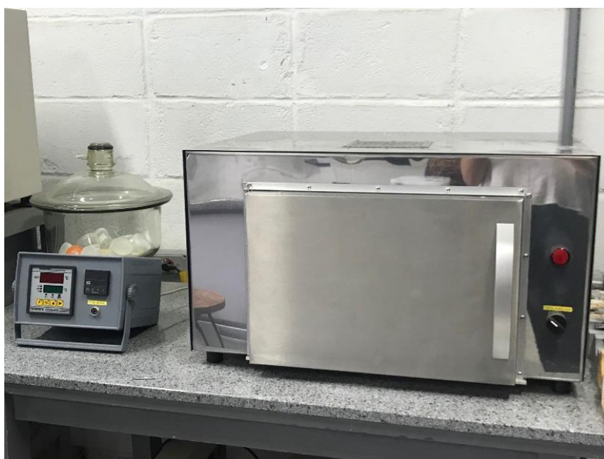
Figura 4 – Forno FMO-1200 utilizado para cristalização em micro-ondas
