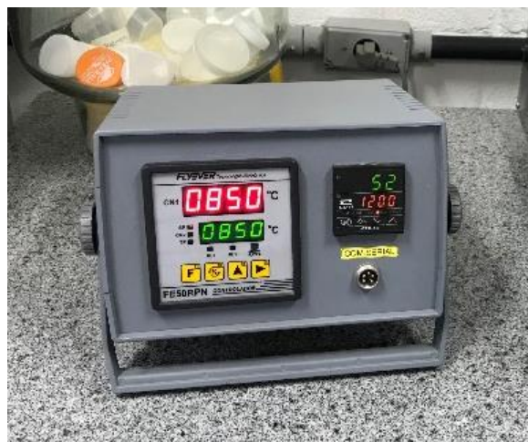
Figura 7 – Visor do forno de micro-ondas mostrando 850°C (temperatura de cristalização)
