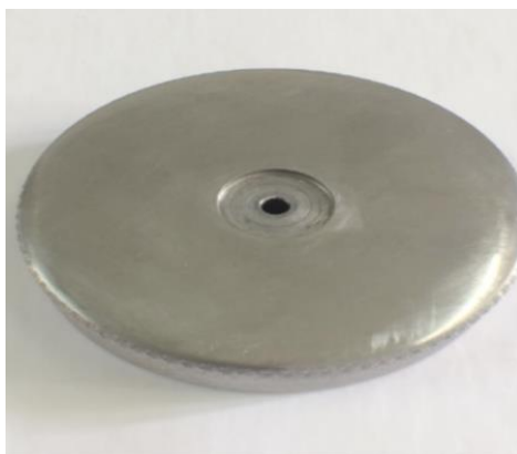
Figura 2 – Matriz utilizada para auxiliar o polimento das amostras
