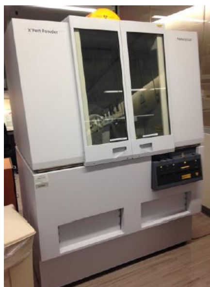
Figura 10 – Difratorômetro utilizado para a mensuração das amostras
