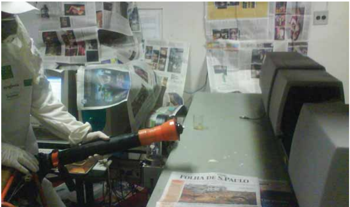
Figura 5. Aplicação com equipamento Multispray para a avaliação do DMV, coeficiente de uniformidade e porcentagem de gotas com diâmetro igual ou inferior a 15\mu\text{m} , medidas por meio de um analisador de partículas em tempo real, Mastersizer S versão 2.19 da Malvern Instruments Ltd. Jaboticabal, 2010.
