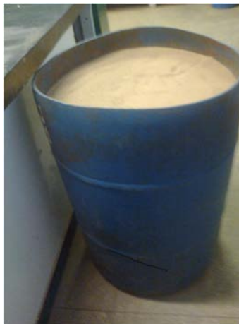
Figura 21 - Tambor de areia de rio para ensaio do DPL CEFET instrumentado.
