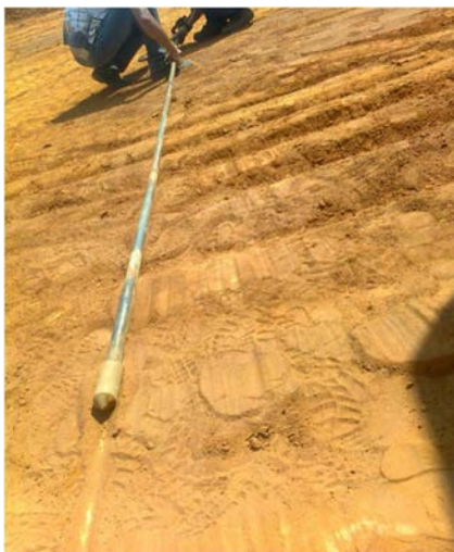
Figura 4 - Ensaio de campo com instrumento DPL CEFET em Nova Mutum
