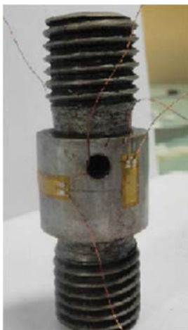
Figura 17 - Terminais dos sensores ligados em ponte.
