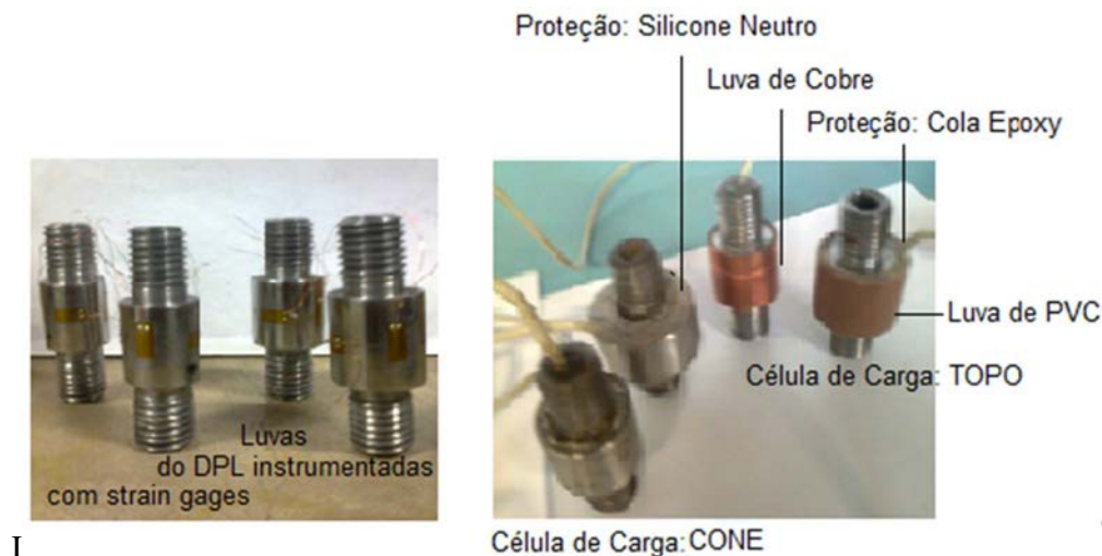
Figura 20 - Proteção das células: cobre, PVC e epoxy.
