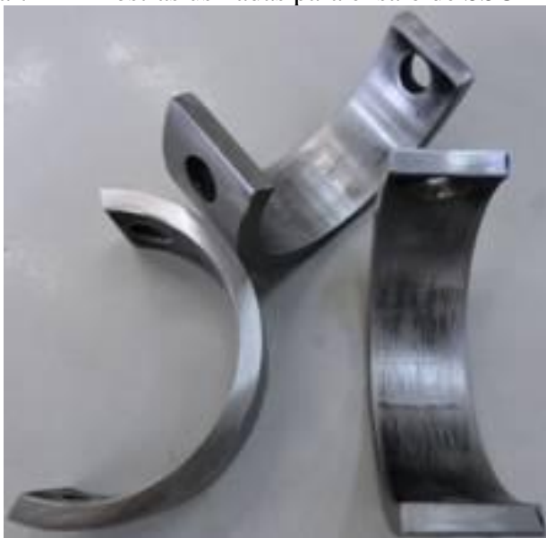
Figura 71 - Amostras usinadas para ensaio de SSC – Método C-Ring (NACE TM0177)
