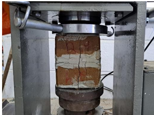
Figura 10 - Tijolos submetidos ao ensaio de resistência à compressão simples.
