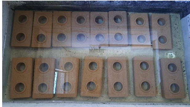
Figura 8 - Tijolos ecológicos em imersão para ensaio de absorção de água.
