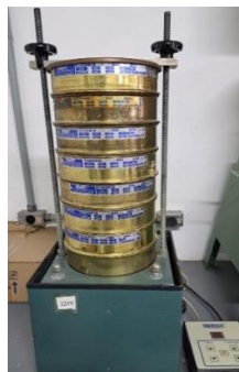
Figura 5 – Peneiramento do solo em agitador mecânico.
