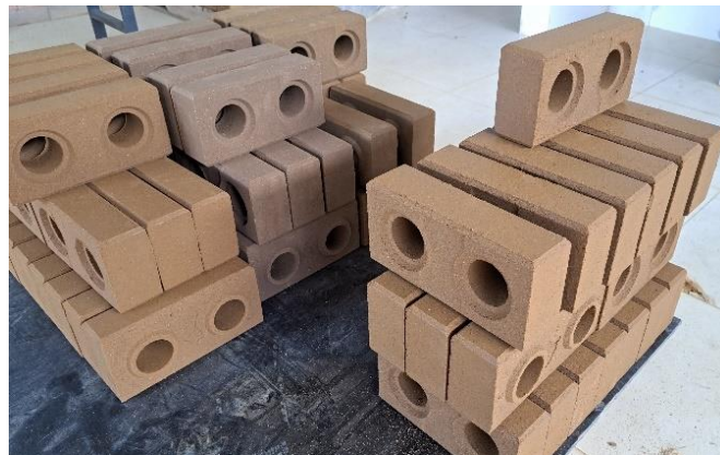
Figura 7 - Tijolos ecológicos produzidos com diferentes proporções solo:termiteiro:cimento
