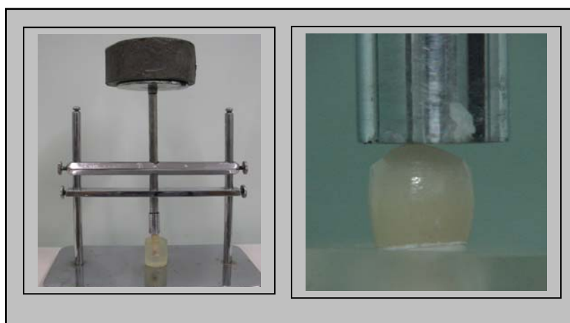
Figura 11 – Cimentação sob carga de 500 g em prensa vertical.
