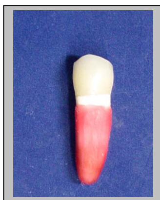
Figura 12 – Corpo-de-prova com alívio de cera na raiz.
