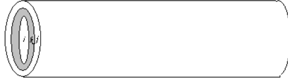
Figura 2.2: Ilustração da perda gerada (gramatura k ) quando se faz a mudança do tipo de papel i para o tipo j .
