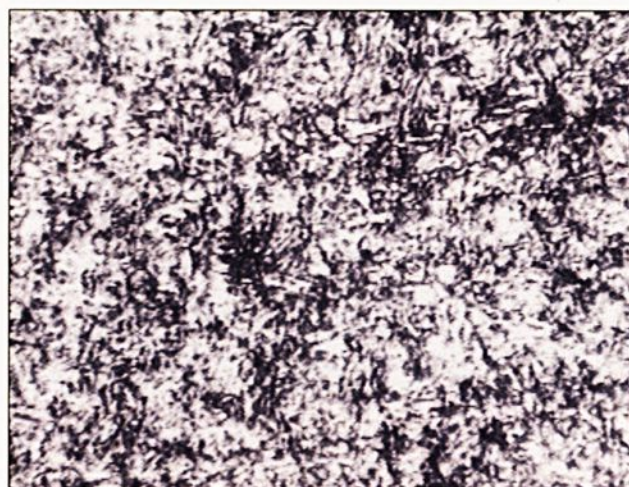
FIGURA 4.59 (200x) – Amostra metalográfica do aço ABNT 4340 – temperado e revenido (39 HRC). Martensita revenida.
