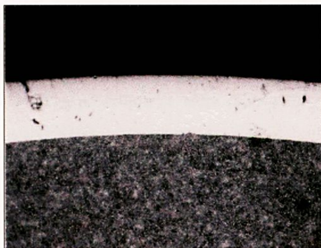
FIGURA 4.62 (100x) – Cdp revestido com cromo duro convencional (160 \mu\text{m} ). Fraturado a 78% \sigma_e . 61
