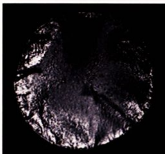
FIGURA 4.31-Cdp revestido com cromo duro aditivado (100 \mu\text{m} ) e fraturado a 47,5% \sigma_e .
