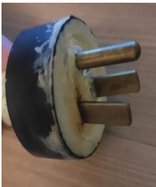
Figura 3 - Sonda totalmente impermeabilizada, evidenciando as hastes utilizadas para leitura.
