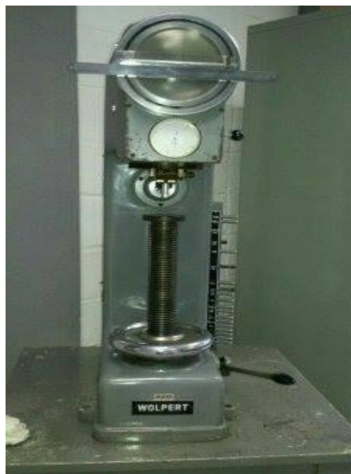
Figura 21 – Durômetro para o ensaio de dureza Brinell
