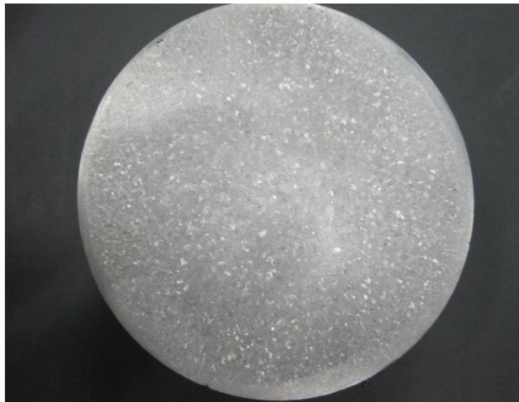
Figura 24 - macrografia da peça fundida em molde metálico
