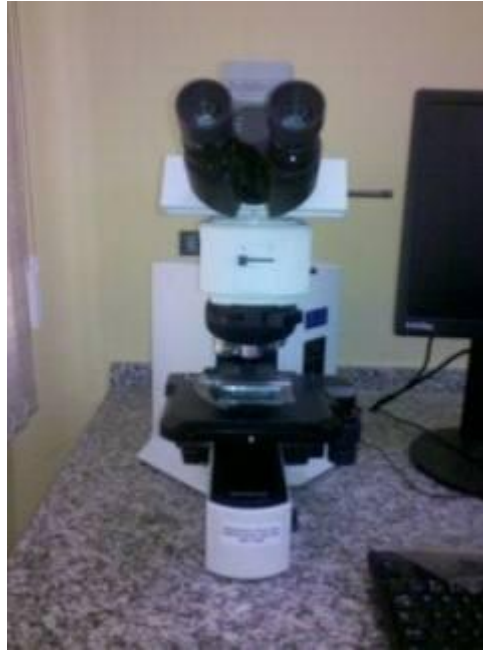
Figura 19 – Microscópio óptico utilizado para Micrografia
