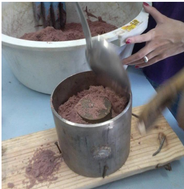
Figura 11 – Fabricação do molde de areia
