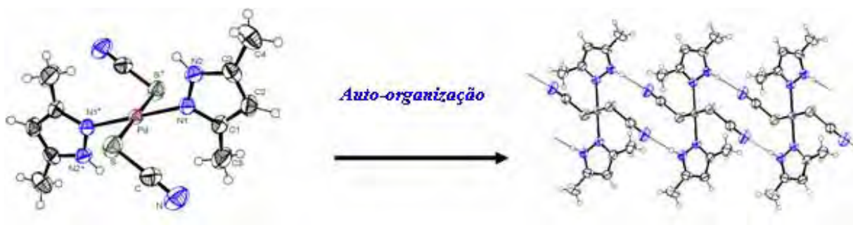
Figura 4. Auto-organização dos building blocks [Pd(SCN)_2(HdmPz)_2] formando espécie supramolecular unidimensional via ligações de hidrogênio[16].
